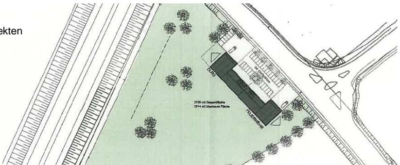
Die Varianten 1 und 2 sehen aufgrund der topographischen Situation Zufahrtsrampen von der Mannheimer Straße aus vor. Eine direkte Einsicht und Zufahrt in die Fahrzeughallen ist damit nicht möglich. Trotz des geschickten Umgangs mit der Topographie können diese Lösungen für die Gerätehäuser nicht überzeugen.
